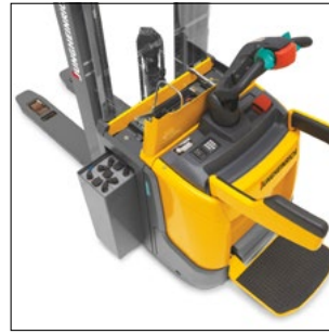
Заміна батареї збоку
